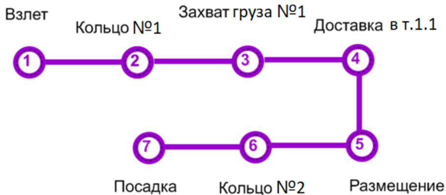
Рис.2. Вариант схемы перемещения квадрокоптера,
